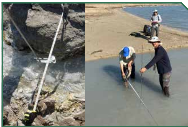
תמונות 7 ו-8: אנשי השירות ההידרולוגי מודדים ספיקה. יש למדוד לשם כך את מהירות הזרימה ואת שטח החתך של התעלה. ליאו מחזיק "מד זרם" מעין פרופלור מתכתי שמסתובב בגלל זרימת המים. הפרופלור מסתובב 30 שניות ולפי מספר הסיבובים ניתן לדעת מה מהירות הזרימה.
