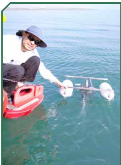
תמונה 11: פרופ' נדב לנסקי בשעת המדידה. מודדים פרמטרים שונים של המים בעומקים שונים (בבת אחת!) ובמרחקים שונים מהנביעות בעינות צוקים
